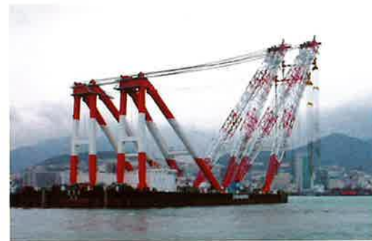
3000Ton フローティングクレーン (船体建造)
