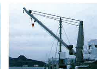
電気式クレーン
